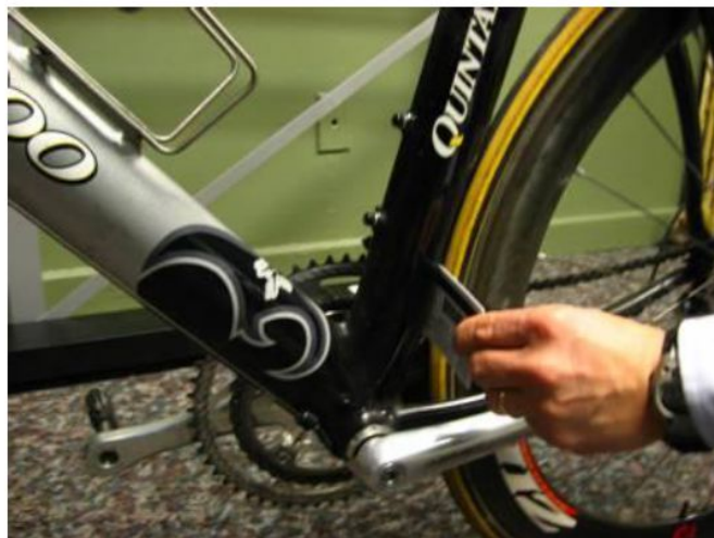
Figure 53 : Insertion d'une carte rigide entre la roue et le cadre afin de vérifier l'absence de carénage
